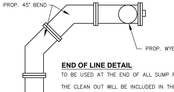
TO BE USED AT THE END OF ALL SUMP PUMP DRAINS.
